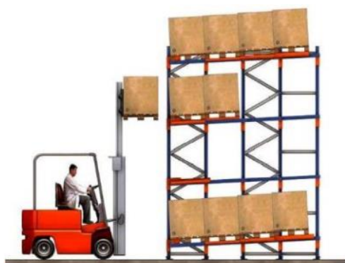
Схема палетного стелажу Push Back
