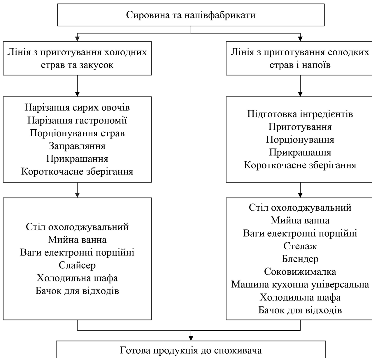
Схема організації виробничого процесу в холодному цеху ресторану «H-Food Rest»
