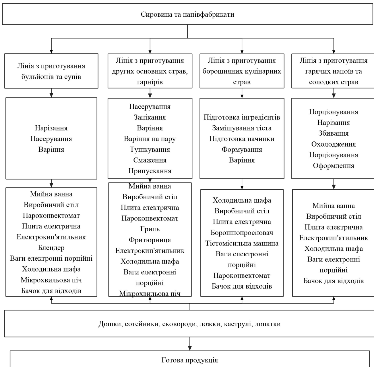
Схема організації виробничого процесу гарячого цеху ресторану «КолоЛока»
