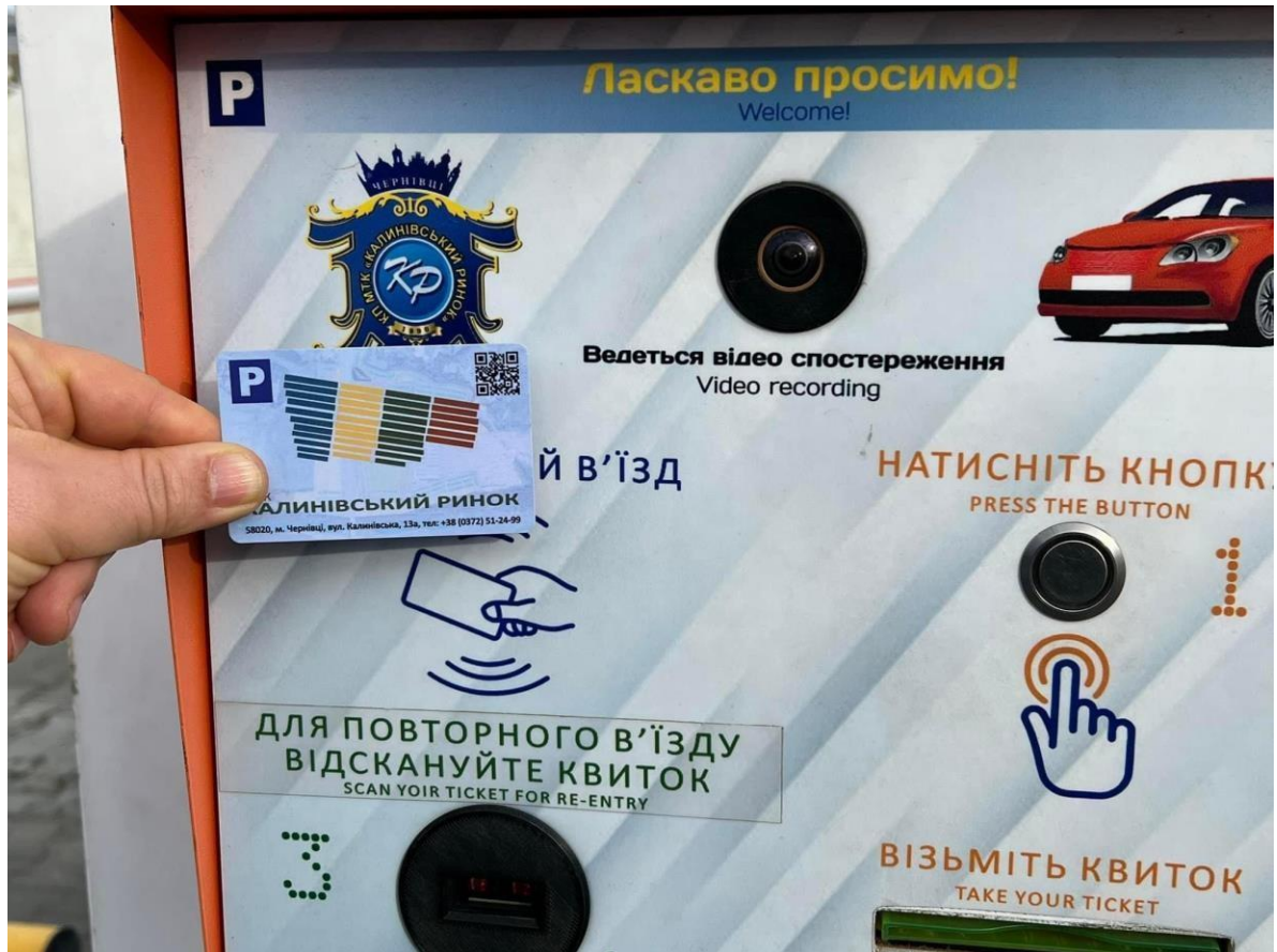
Рис. 2.1. Термінал автоматичного заїзду/виїзду на територію КП МТК «Калинівський ринок»
