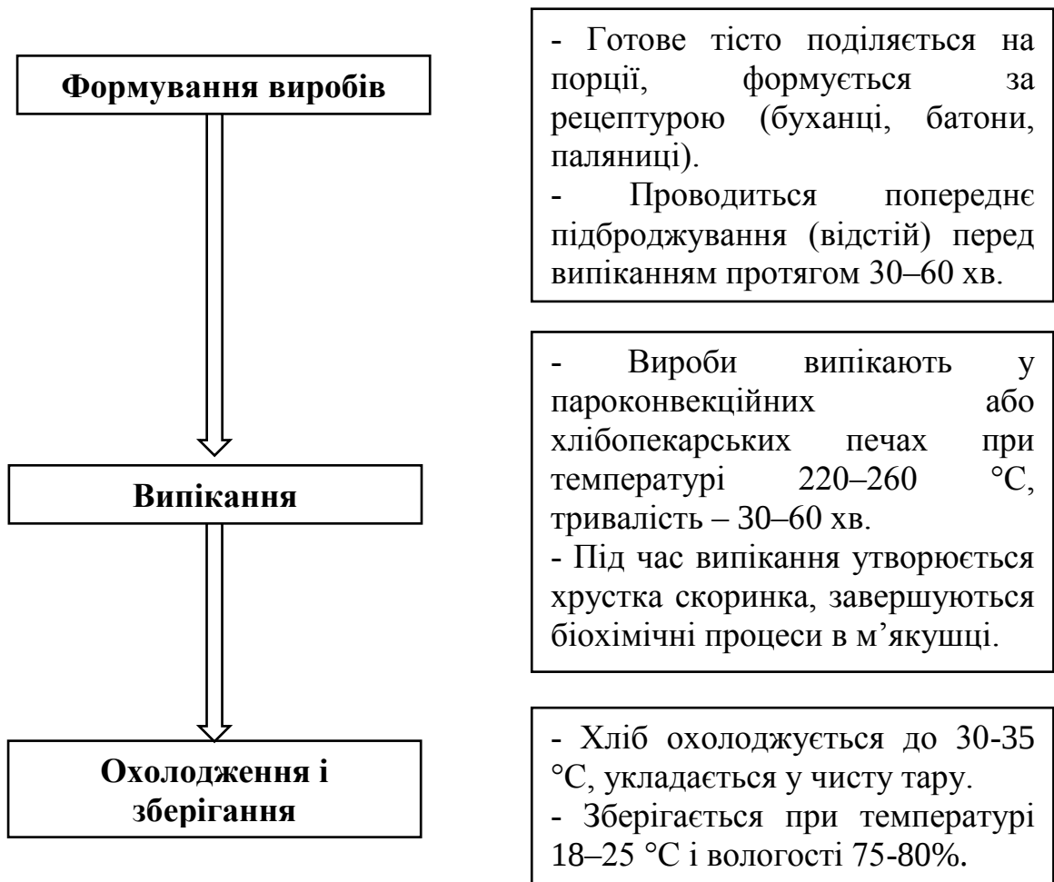
Рис. 2.8. Етапи технологічного процесу формування та випікання хліба
