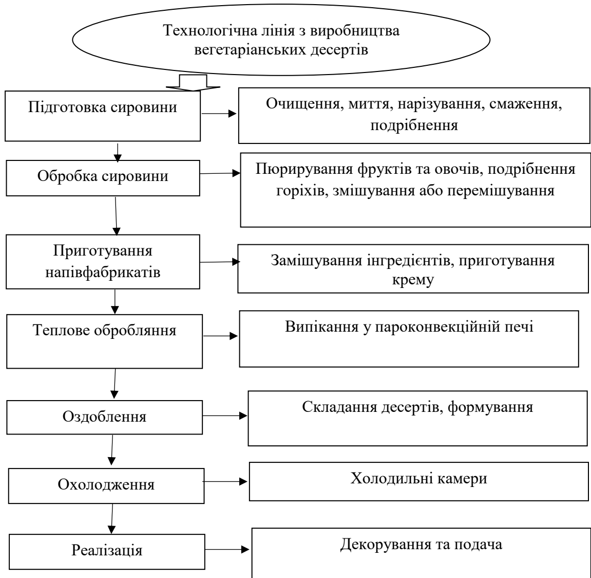
Рис. 2.1. Загальна схема технологічної лінії з виробництва вегетаріанських десертів
