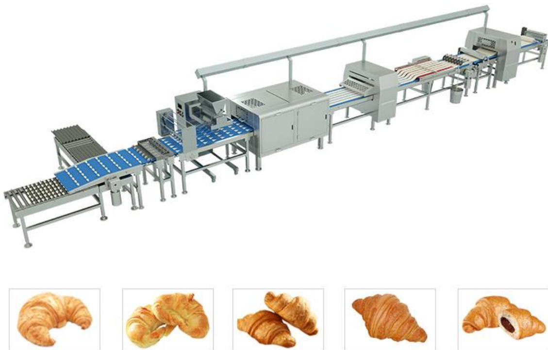
Рис. 1.3. Загальний вигляд автоматизованої лінії з виробництва круасанів та асортимент виробів
