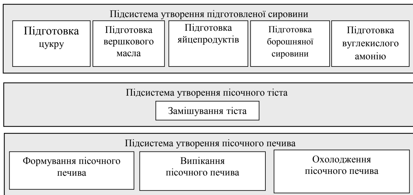
Рис. 2. Графічна модель технологічної системи виробництва пісочного печива
