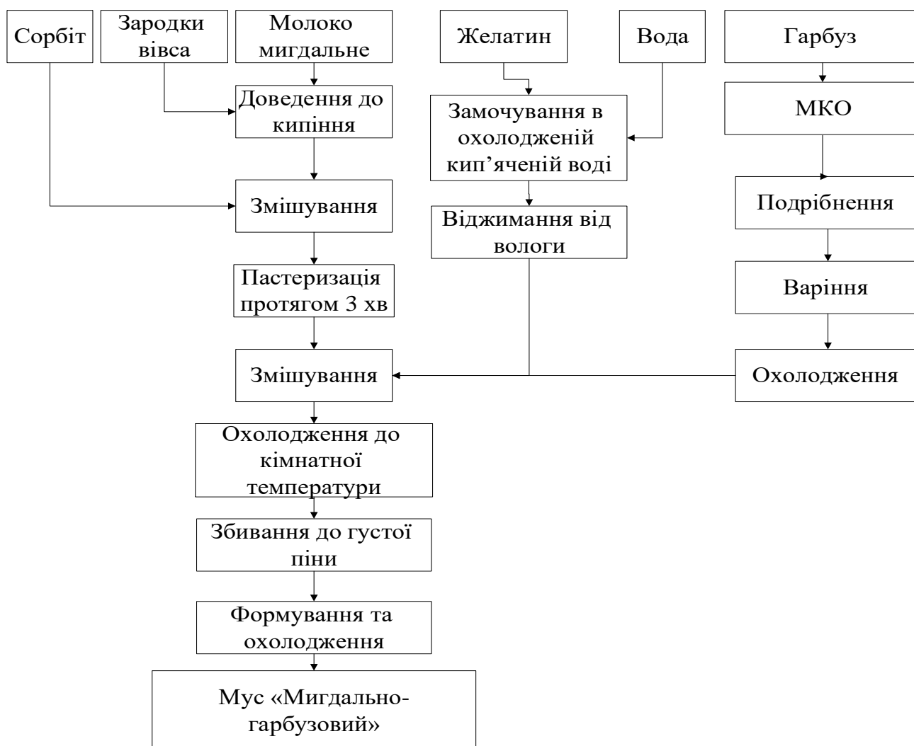
Рис. 2.1. Технологічна схема приготування десерту мус «Мигдально-гарбузовий»
