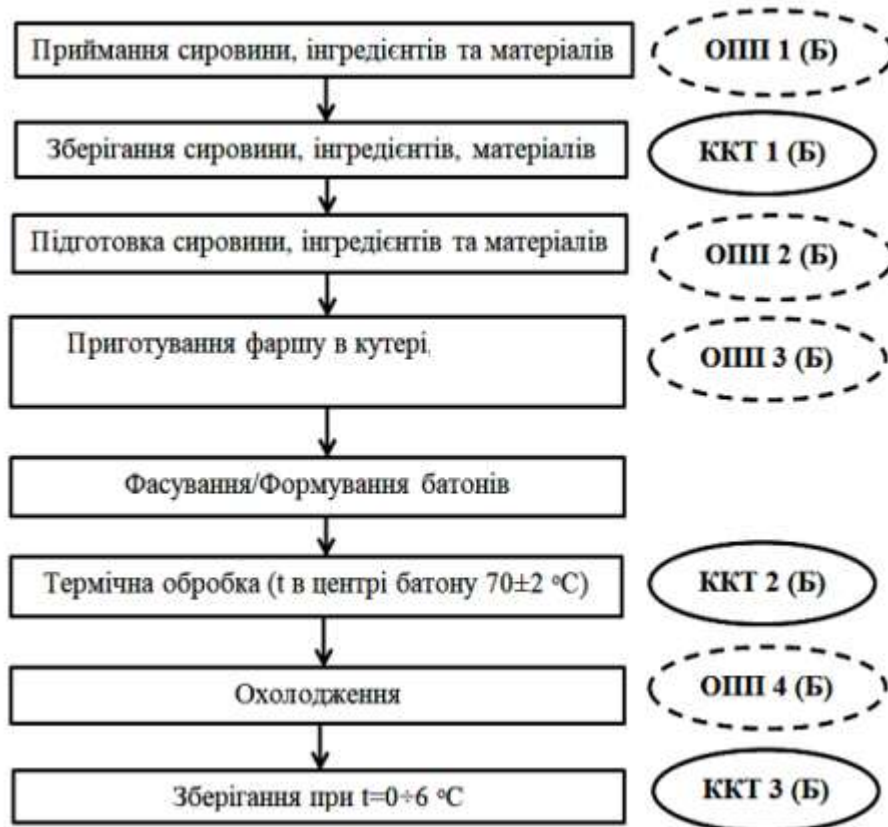
Рис.2.11. Блок-схема технологічного процесу виробництва паштету «М'ясний» з насінням конопель
