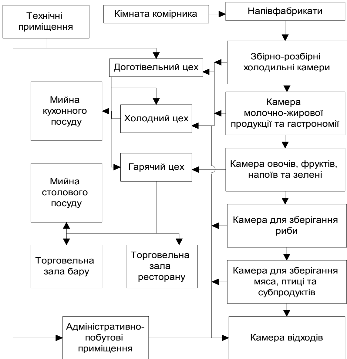
Рис. 2.2. Структурно-технологічна схема виробничого процесу закладу
