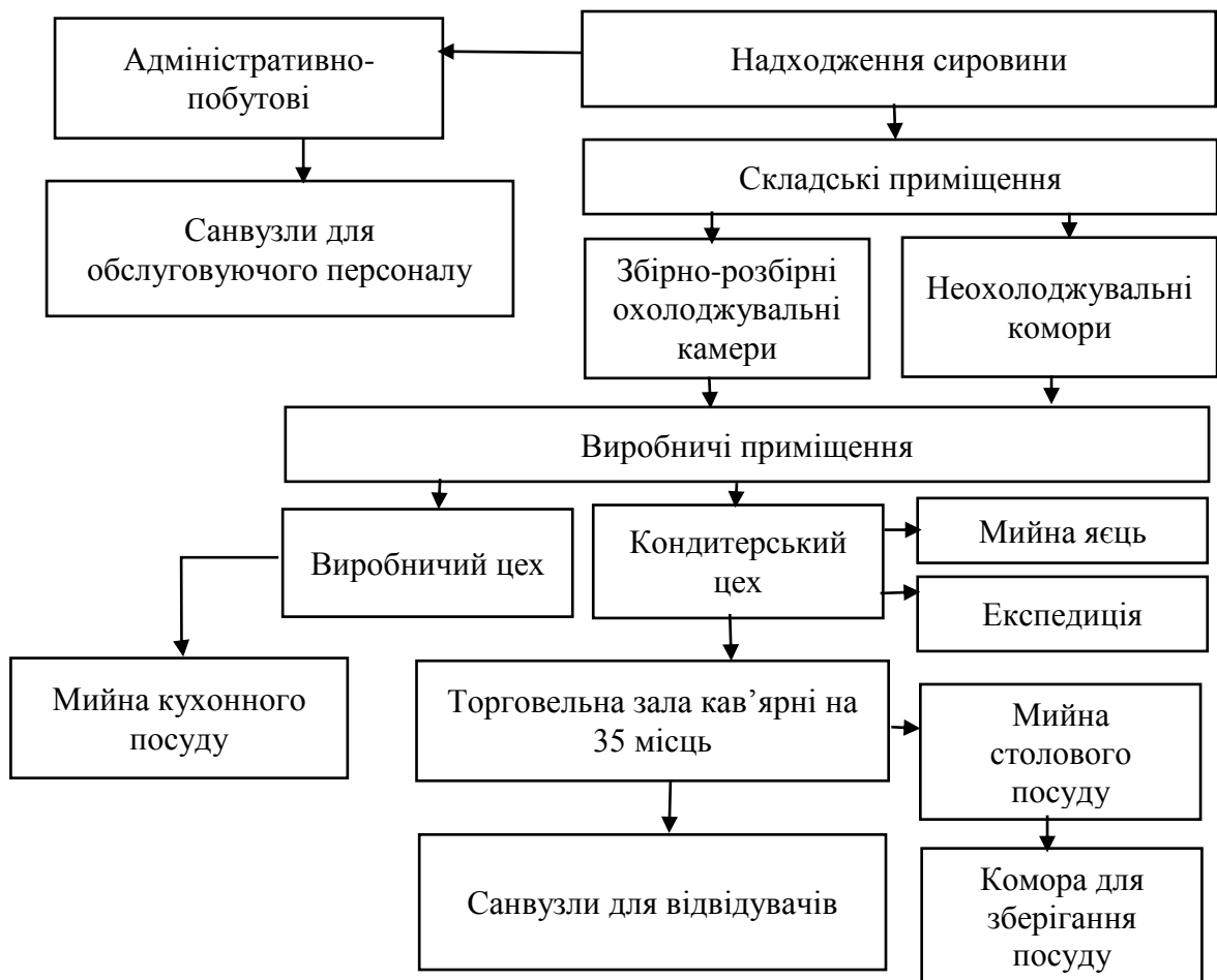
Рис. 2.1 Структурно-технологічна схема кав'ярні на 35 місць
